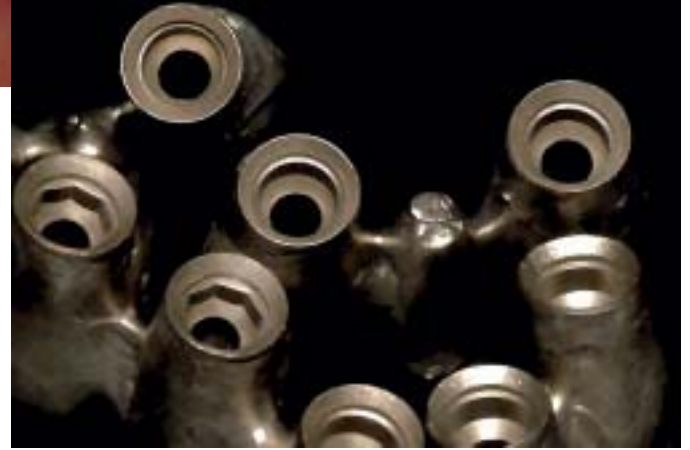
Abb. 4 Gerüste nach dem Guss. Die Innenflächen sind tadellos und frei von Gussfahnen oder Riefen.
